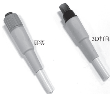
图7 外部包胶注射成型后 3D 打印线缆连接器与真实零件对比
