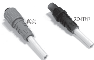
图6 内部芯模注射成型后 3D 打印线缆连接器与真实零件对比
